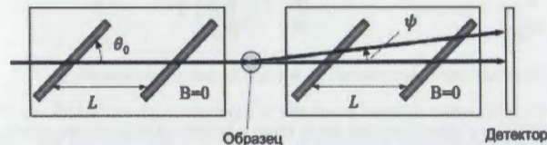
Рис. 28. Схема ГМП НСЭ дифрактометра.
